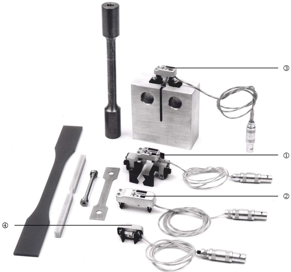
Das **Titelfoto** zeigt EXTENSOMETER für die gleichzeitige Messung der Axial- und Diametralenveränderung an einer Rundprobe.
