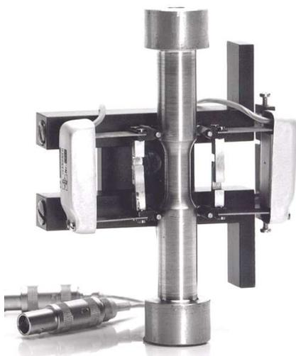
Abb. 2 zeigt ein Doppel-Extensometer als Sonderausführung, nach Kundenwunsch mit 25 mm Messbasis und  $\pm 2,5$  mm Messweg. Doppel-Axial-Extensometer sind ab Messbasis 25 mm lieferbar.
