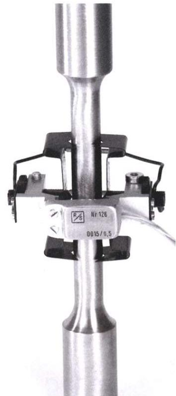
Die nebenstehende Abbildung zeigt einen Diametral-EXTENSOMETER **EXD 15-0,5** an einer Rundprobe von 8 mm Durchmesser.
